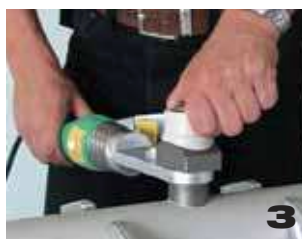
Вварное седло надеть на насадку так, чтобы были совмещены риски на седле и наконечнике.
